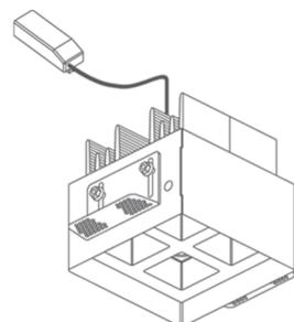
Установка ниже уровня поверхности с монтажным коробом
