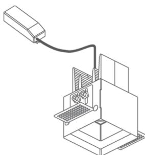
Установка ниже уровня поверхности с монтажным коробом
