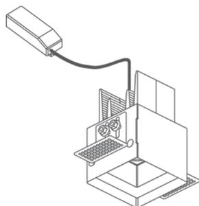
Установка ниже уровня поверхности с монтажным коробом
