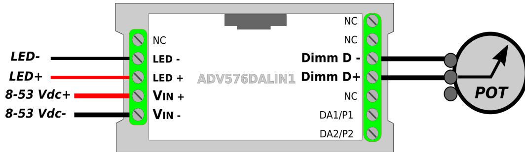
Collegamento potenziometro (fig. 3) / Potentiometer connection (pic. 3)
