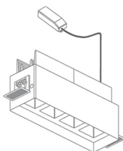
Installation en retrait avec boîtier d'encastrement
