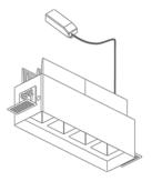
Installation en retrait avec boîtier d'encastrement
