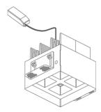
Installation en retrait avec boîtier d'encastrement
