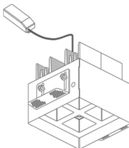
Installation en retrait avec boîtier d'encastrement
