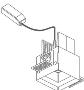
Installation en retrait avec boîtier d'encastrement
