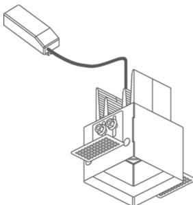
Installation en retrait avec boîtier d'encastrement
