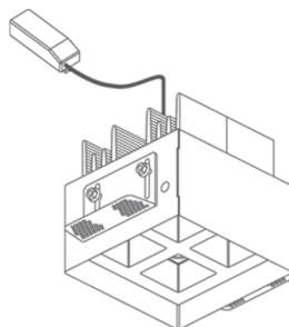
Rückversetzte Installation mit Einbaugehäuse
