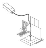
Rückversetzte Installation mit Einbaugehäuse
