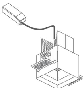
Rückversetzte Installation mit Einbaugehäuse
