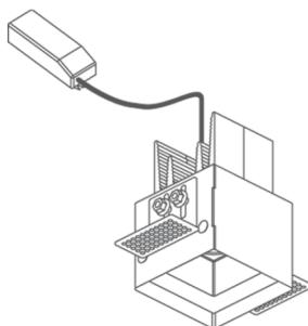
Rückversetzte Installation mit Einbaugehäuse
